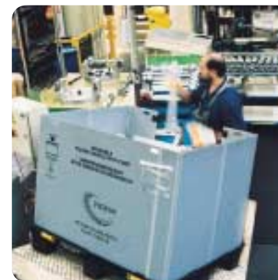
Entnahmeklappen für einfachen Zugang. Drop door gives easy access for filling the containers.
