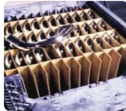
Spezielle Einsätze zum Schutz Ihrer Produkte. Special dunnage to protect your parts.
